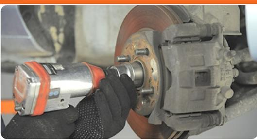
Lösen und entfernen der Nabenmutter.
