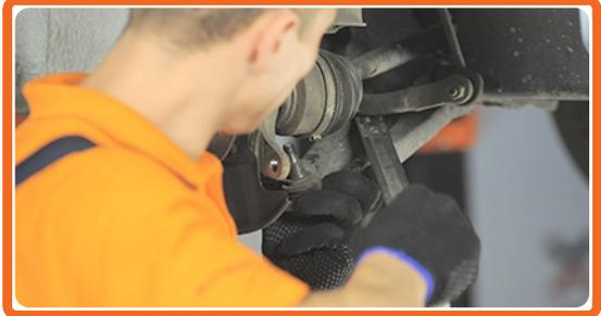
Schließen Sie das Kugelgelenk des Querlenkers am Achsschenkel an und installieren Sie die Kugelgelenk-Befestigungsschraube.
