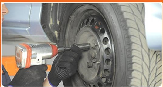
Lösen Sie die Radhalterungsschrauben
