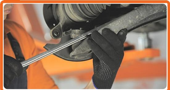
Schrauben Sie die Spurgelenkmutter ab. Entfernen Sie das Kugelgelenk aus dem Achsschenkel.
