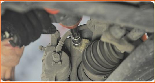
Schrauben Sie die Befestigung des Bremssattels ab
