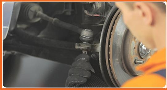
Verbinden Sie den Spurstangenkopf mit dem Achsschenkel und befestigen Sie diesen.
