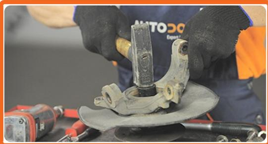
Drücken Sie die Radnabe aus dem Kegelrollenlager.
