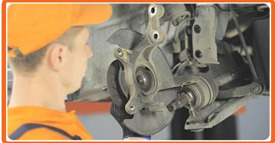
Entfernen Sie die Achsschenkel zusammen mit der Nabe.
