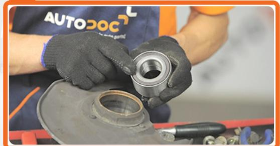
Montieren Sie das Nebenlager so, dass sich die ABS-Magnetleiste auf der Radnaabeninnenseite befindet.
