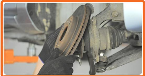
Bringen Sie die Bremsscheibe an und sichern Sie diese.
