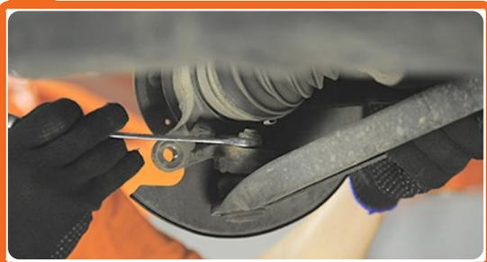
Schrauben Sie die Befestigungsmutter des Kugelgelenks ab.
