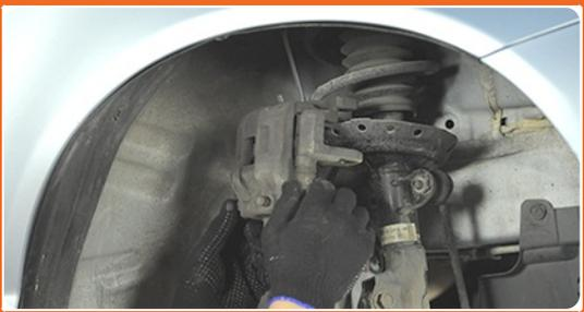
Binden Sie die Zange an die Aufhängung oder an den Körper mit einem Draht, ohne den Bremschlauch zu trennen, um eine Entspannung des Bremssystems zu verhindern.
