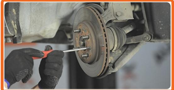
Lösen Sie die Bremsscheiben-Befestigungsschrauben und entfernen sie diese.
