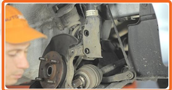
Installieren Sie den Achsschenkel in dem Radkasten und führen Sie die Gelenkwelle durch die Nabenmitte.
