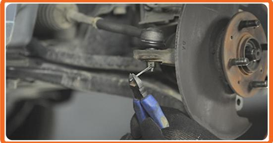
Lösen Sie das Ende der Befestigungsmutter an dem Achsschenkel.
