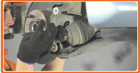
Entfernen Sie die Gelenkwelle von der Radnabe.
