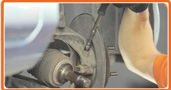
Entfernen Sie den ABS-Sensor vom Achsschenkel.
