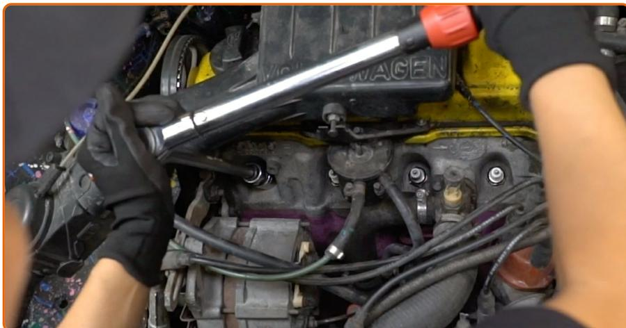
Schrauben Sie die neuen Zündkerzen an und ziehen Sie diese fest. Verwenden Sie die Zündkerzennuss # 21. Verwenden Sie einen Drehmomentschlüssel. Ziehen Sie ihn mit 25 Nm Drehmoment fest.
