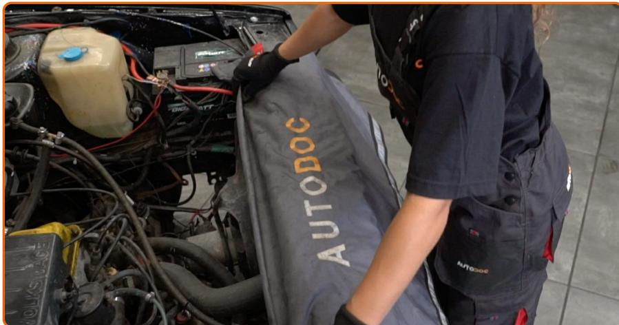
Verwenden Sie eine Kotflügel-Schutzabdeckung, um Schäden an der Lackierung und den Kunststoffteilen des Autos zu verhindern.
