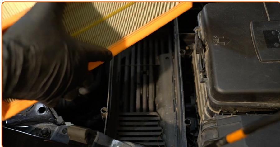
Entfernen Sie das Filterelement aus dem Filtergehäuse.
