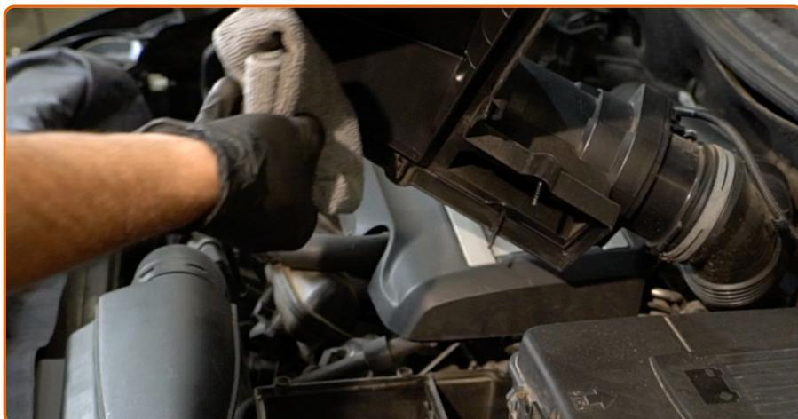
Entfernen Sie das Mikrofasertuch vom Luftansaugschlauch.
