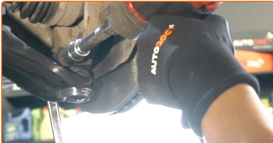
Schrauben Sie die Befestigungen des Kugelgelenks ein. Verwenden Sie Ring-Gabelschlüssel Nr. 18. Verwenden Sie Stecknuss Nr. 18. Verwenden Sie ein Windeisen.
