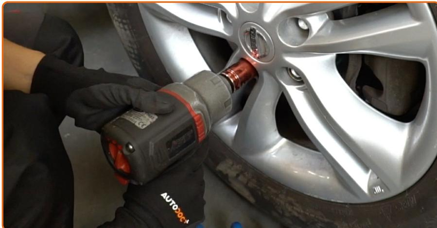
Schrauben Sie die Radbolzen fest. Verwenden Sie eine Schlagschlüssel für Felgen # 21.
