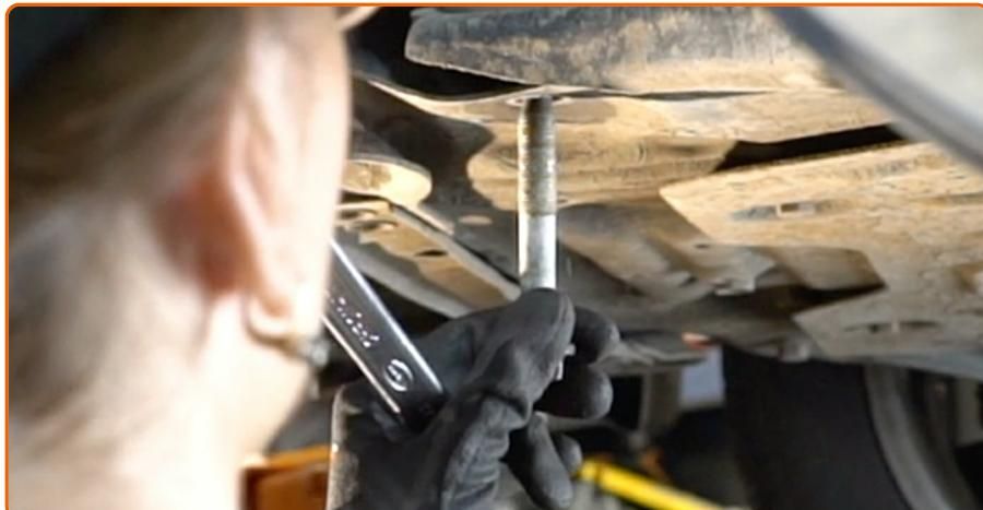
Lösen Sie die hintere Befestigung des Querlenkers.
