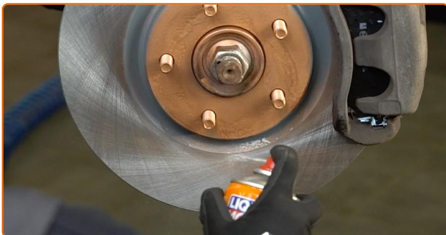
Die Bremsscheibenoberfläche reinigen. Benutzen Sie einen Bremsenreiniger.
