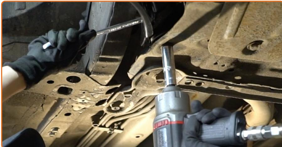
Schrauben Sie das hintere Befestigungselement ein, das den Querlenker mit dem Hilfsrahmen verbindet. Verwenden Sie Ring-Gabelschlüssel Nr. 16. Verwenden Sie Stecknuss Nr. 18. Verwenden Sie einen Ratschenschlüssel.
