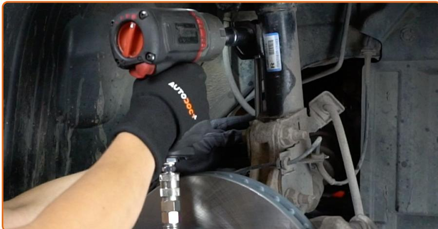
Schrauben Sie das Befestigungselement heraus, das die Druckstange mit dem Federbein verbindet. Verwenden Sie Stecknuss Nr. 19. Verwenden Sie einen Ratschenschlüssel.
