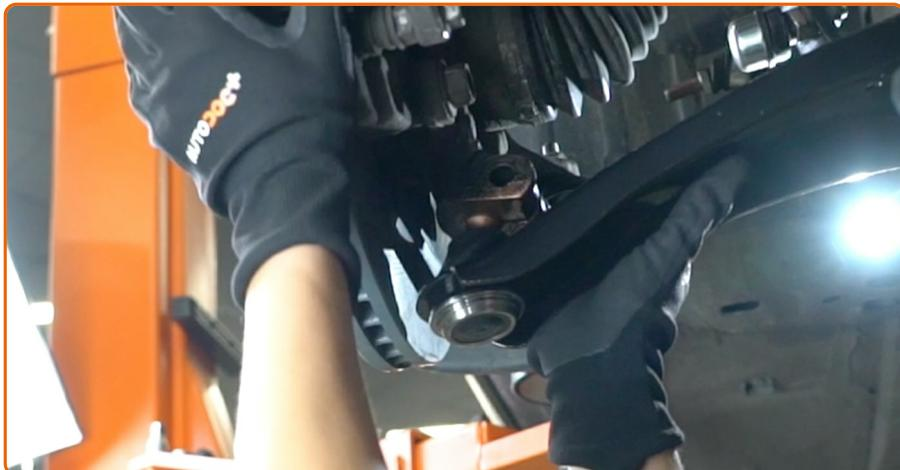
Verbinden Sie das Kugelgelenk mit dem Achsschenkel.
