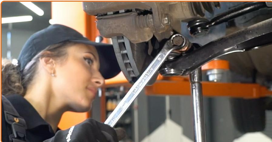
Ziehen Sie das Kugelgelenk an. Verwenden Sie Ring-Gabelschlüssel Nr. 18. Verwenden Sie Stecknuss Nr. 18. Verwenden Sie einen Drehmomentschlüssel. Ziehen Sie ihn mit 60 Nm Drehmoment fest.
