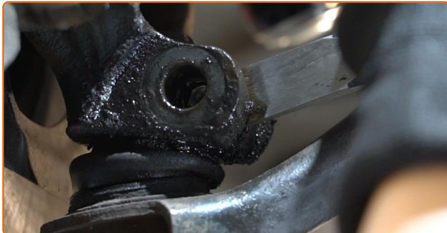
Setzen Sie das Verbindungselement, welches das Kugelegelenk mit dem Achsschenkel verbindet, frei. Verwenden Sie einen flachen Metallmeißel. Benutzen Sie einen Hammer.
