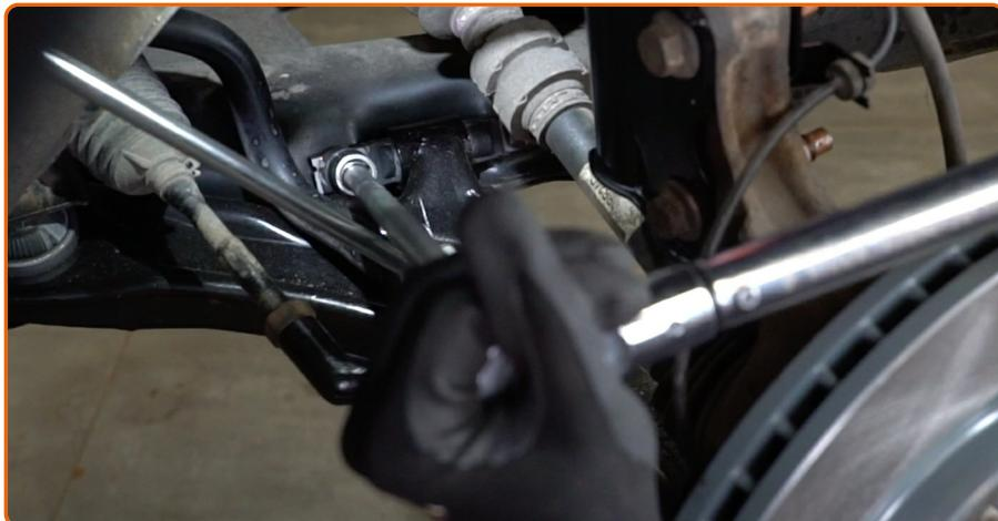
Ziehen Sie das vordere Befestigungselement an, das den Querlenker mit dem Hilfsrahmen verbindet. Verwenden Sie Stecknuss Nr. 21. Verwenden Sie einen Drehmomentschlüssel. Ziehen Sie ihn mit 80 Nm Drehmoment fest.
