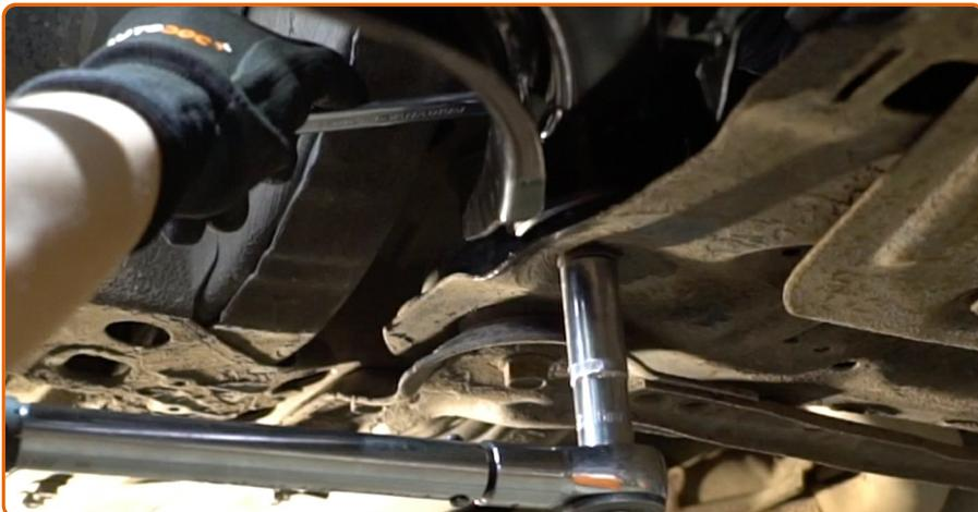
Schrauben Sie die hinteren Befestigungen, welche den Querlenker mit dem Karosseriehilfsrahmen verbinden, fest. Verwenden Sie Ring-Gabelschlüssel Nr. 18. Verwenden Sie Stecknuss Nr. 18. Verwenden Sie einen Drehmomentschlüssel. Ziehen Sie ihn mit 75 Nm Drehmoment fest.
