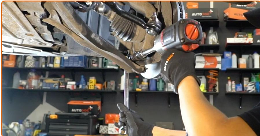
Schrauben Sie die Kugelgelenkbefestigung vom Achsschenkel ab. Verwenden Sie Ring-Gabelschlüssel Nr. 18. Verwenden Sie Stecknuss Nr. 18. Verwenden Sie ein Windeisen.
