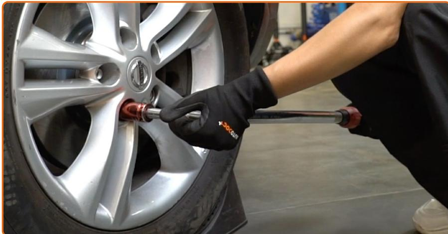
Senken Sie das Auto und ziehen Sie die Radschrauben über Kreuz an. Verwenden Sie eine Schlagschlüssel für Felgen # 21. Verwenden Sie einen Drehmomentschlüssel. Ziehen Sie ihn mit 120 Nm Drehmoment fest.
