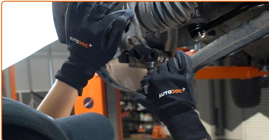
Trennen Sie das Kugelgelenk vom Achsschenkel. Benutzen Sie ein Brecheisen.
