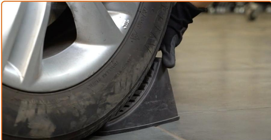
Entfernen Sie den Wagenheber sowie die Unterlegkeile.
