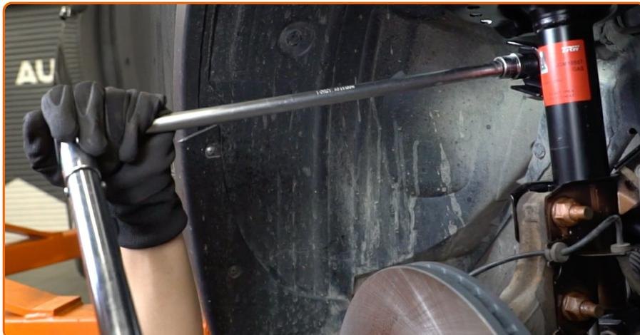
Ziehen Sie das Befestigungselement an, das die Druckstange mit dem Federbein verbindet. Verwenden Sie Stecknuss Nr. 19. Verwenden Sie einen Drehmomentschlüssel. Ziehen Sie ihn mit 65 Nm Drehmoment fest.
