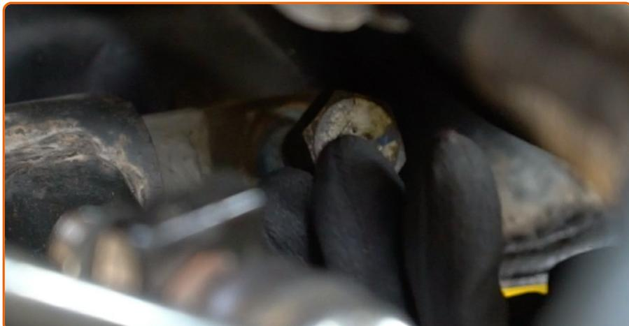
Entfernen Sie die vordere Befestigung des Querlenkers.
