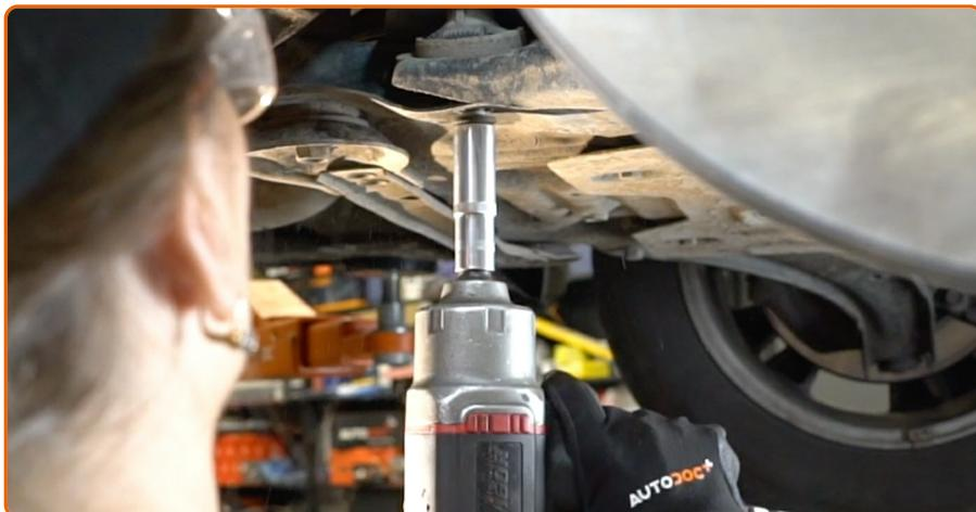
Schrauben Sie das hintere Befestigungselement heraus, das den Querlenker mit dem Hilfsrahmen verbindet. Verwenden Sie Ring-Gabelschlüssel Nr. 16. Verwenden Sie Stecknuss Nr. 18. Verwenden Sie einen Ratschenschlüssel.
