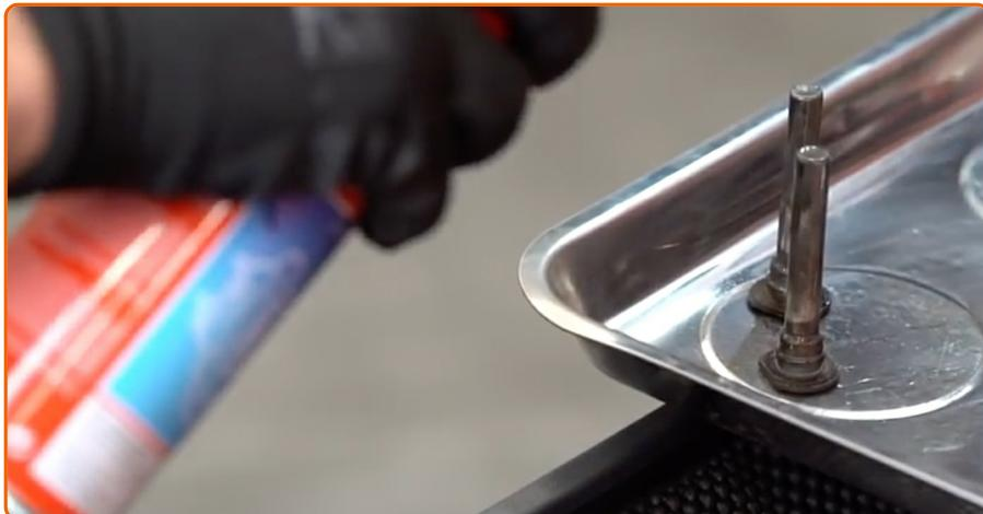
Reinigen Sie die Bremssattel-Führungsstifte.
