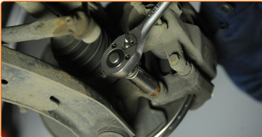
Verwenden Sie Ring-Gabelschlüssel Nr. 15. Verwenden Sie Stecknuss Nr. 13. Verwenden Sie einen Drehmomentschlüssel. Ziehen Sie ihn mit 35 Nm Drehmoment fest.
