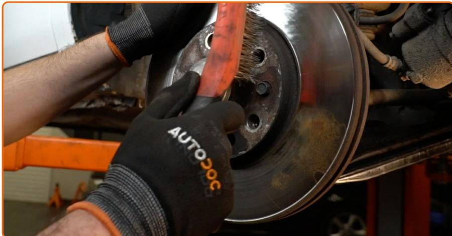
Reinigen Sie die Befestigungselemente der Bremsscheibe. Benutzen Sie eine Drahtbürste. Benutzen Sie WD-40-Spray.
