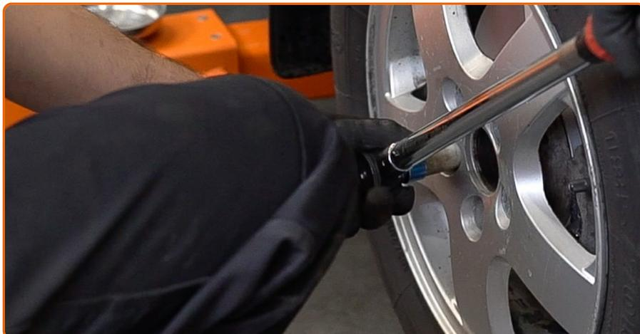
Senken Sie das Auto und ziehen Sie die Radschrauben über Kreuz an. Verwenden Sie eine Schlagnuss für Felgen # 21. Verwenden Sie einen Drehmomentschlüssel. Ziehen Sie ihn mit 125 Nm Drehmoment fest.
