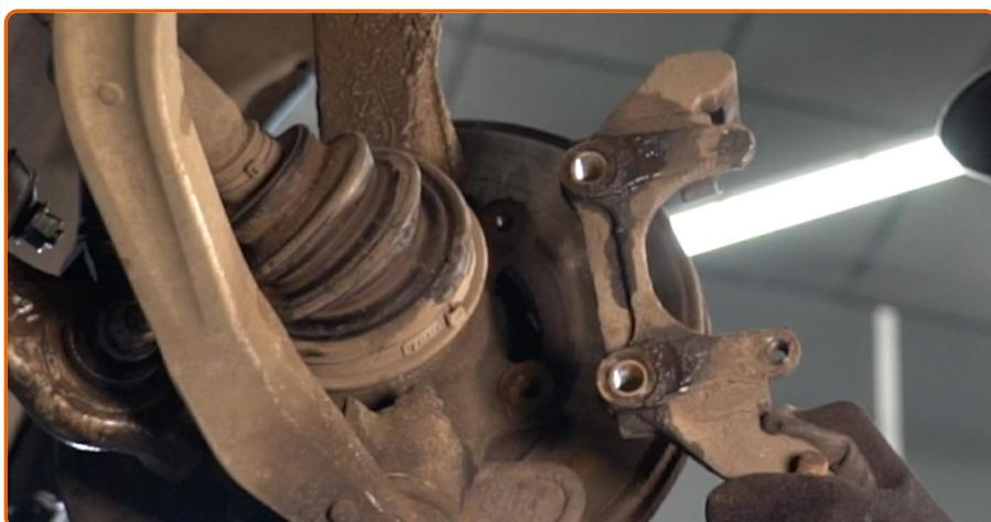
Entfernen Sie die Sattelhalterung.
