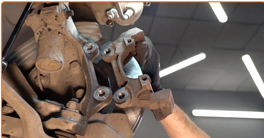
Setzen Sie die Halterung des Bremssattels ein.
