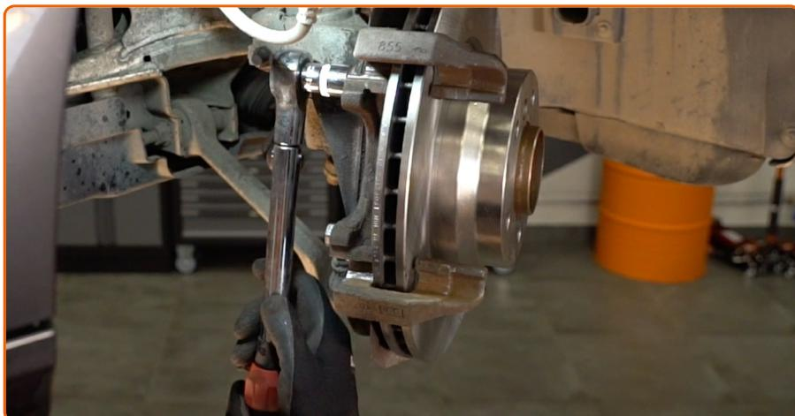
Befestigen Sie die Bremssattelhalterung. Verwenden Sie Stecknuss Nr. 17. Verwenden Sie einen Drehmomentschlüssel. Ziehen Sie ihn mit 75 Nm Drehmoment fest.
