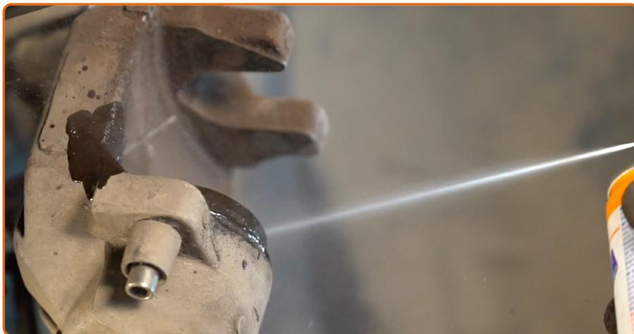
Behandeln Sie den Bremssattel-Kolben. Benutzen Sie einen Bremsenreiniger.
