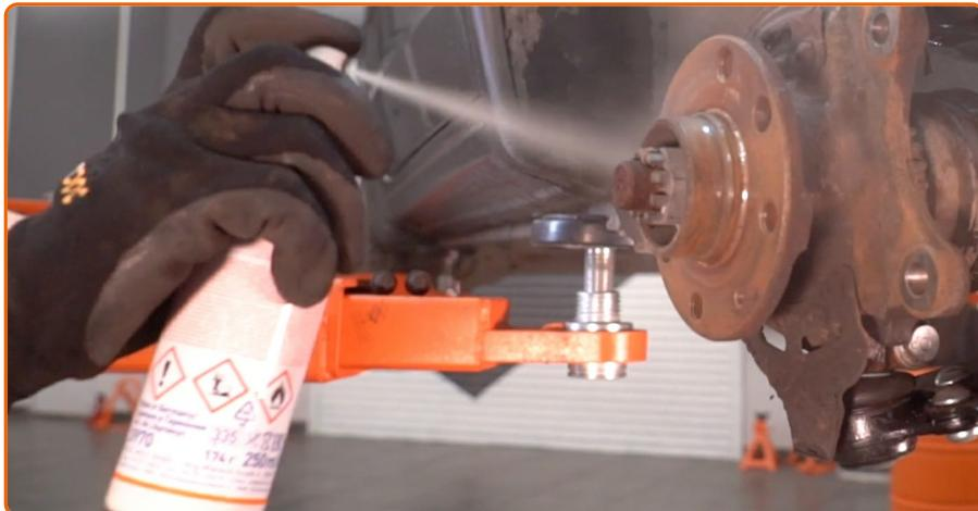
Reinigen Sie die Nabe. Benutzen Sie eine Drahtbürste. Behandeln Sie die Kontaktfläche.
