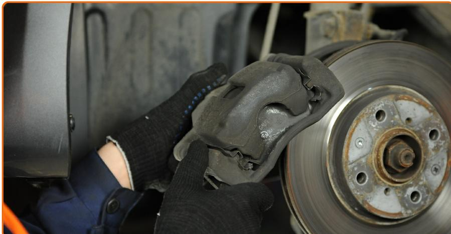
Entfernen Sie den Bremssattel.
