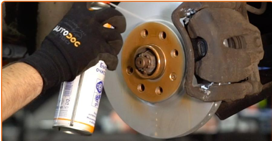
Die Bremsscheibenoberfläche reinigen. Benutzen Sie einen Bremsenreiniger.
