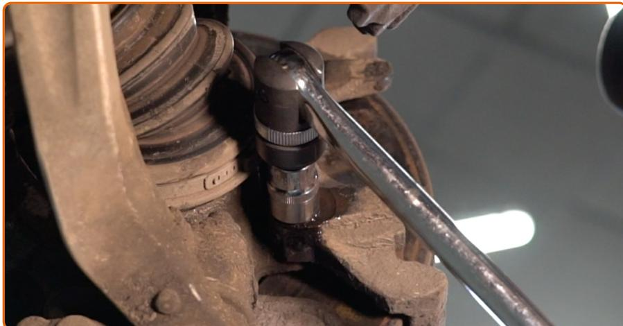
Lösen Sie die Befestigung der Sattelhalterung. Verwenden Sie Stecknuss Nr. 17. Verwenden Sie ein Windeisen. Verwenden Sie einen Ratschenschlüssel.
