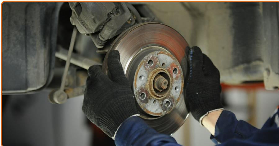
Entfernen Sie die Bremsscheibe.
