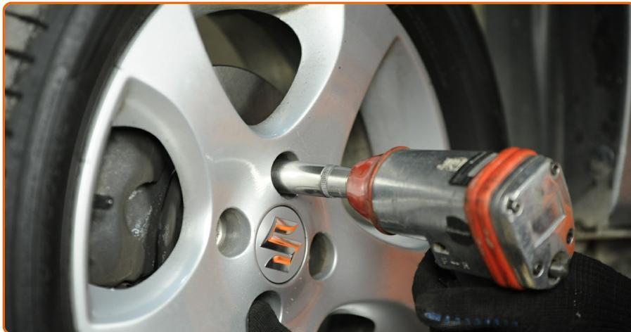
Schrauben Sie die Radbolzen fest. Verwenden Sie eine Schlagnuss für Felgen # 21.
