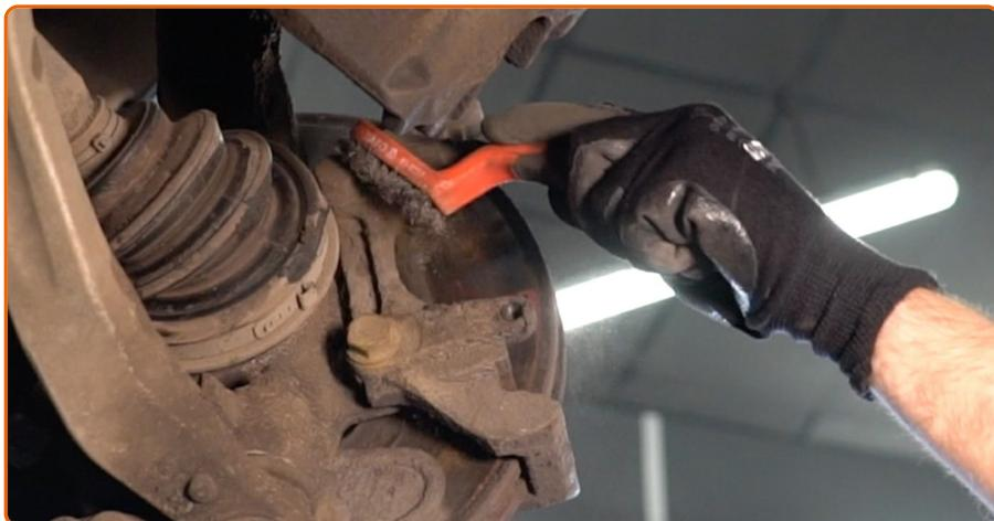
Die Befestigungselemente der Bremssattelhalterung reinigen. Benutzen Sie eine Drahtbürste.
