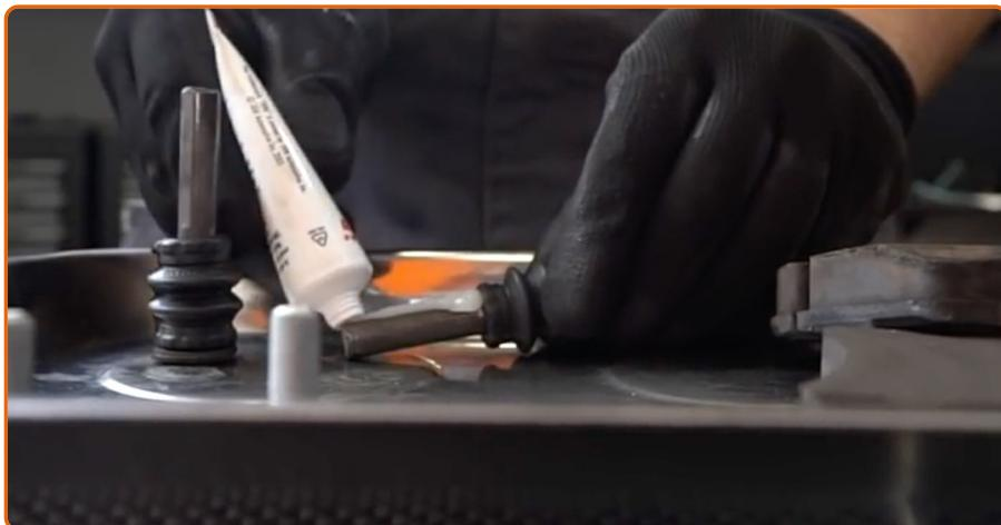
Behandeln Sie die Bremssattel-Führungsstifte. Verwenden Sie das Bremssattelführungsbolzen-Fett.
