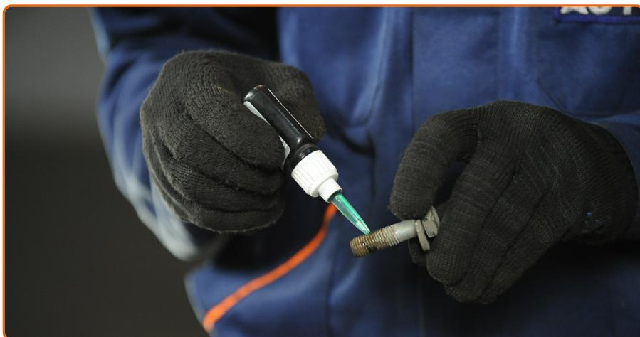
Behandeln Sie die Befestigungsschrauben der Bremssattelhalterung. Verwenden Sie ein Dichtmittel.
