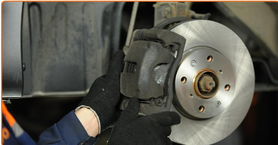
Installieren Sie den Bremssattel und fixieren Sie diesen.
