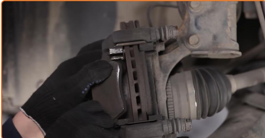
Entfernen Sie die Bremsbeläge.
