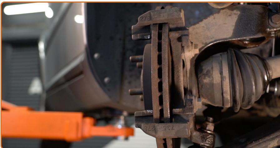
Entfernen Sie die Bremsbeläge. Benutzen Sie ein Brecheisen.
