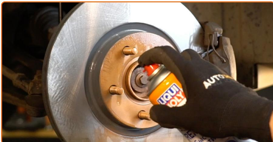
Die Bremsscheibenoberfläche reinigen. Benutzen Sie einen Bremsenreiniger.
