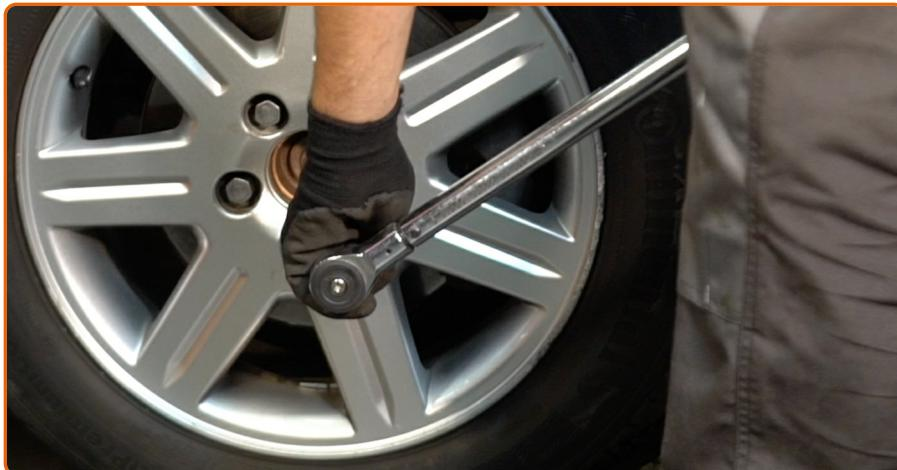
Senken Sie das Auto und ziehen Sie die Radschrauben über Kreuz an. Verwenden Sie einen Drehmomentschlüssel.
