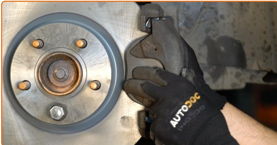
Installieren Sie den Bremssattel und fixieren Sie diesen. Verwenden Sie Inbusschlüssel Nr. H7. Verwenden Sie einen Ratschenschlüssel.
