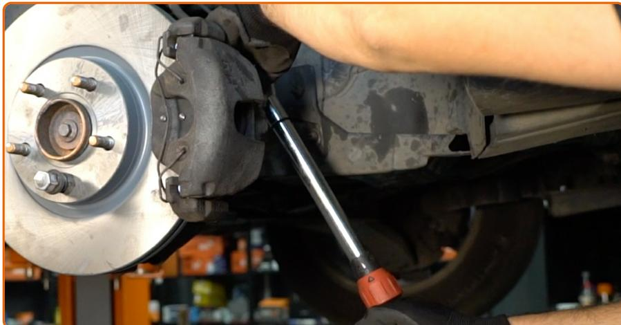
Ziehen Sie die Bremssattelbefestigungen fest. Verwenden Sie Inbusschlüssel Nr. H7. Verwenden Sie einen Drehmomentschlüssel. Ziehen Sie ihn mit 35 Nm Drehmoment fest.
