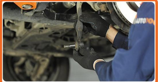
Schrauben Sie das Ende aus der Zugstange.
