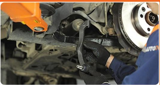
Schrauben Sie einen neuen Spurstangenkopf an
