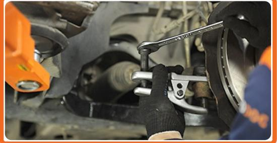
Lösen Sie die Kontermutter des Spurstangenkopf und der Zugstange.
