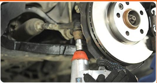
Verwenden Sie ein spezielles Werkzeug, um das Lenkstangenende aus dem Achsschenkel zu schieben.
