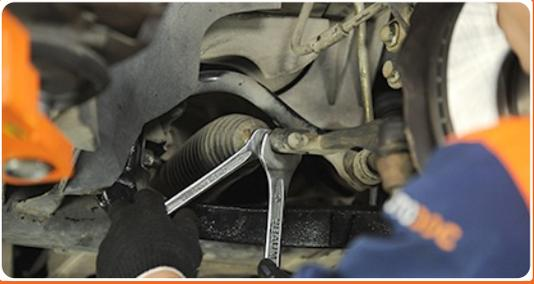
Lösen Sie die Spannmutter des Spurstangenkopf.
