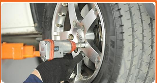
Lösen Sie die Radhalterungsschrauben
