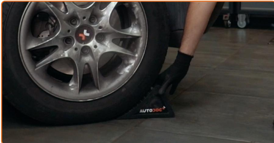
Entfernen Sie den Wagenheber sowie die Unterlegkeile.
