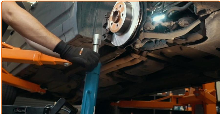
Entfernen Sie den Träger unter dem Arm.
