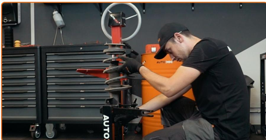
Stellen Sie das Dämpferbein auf das Federspannwerkzeug.
