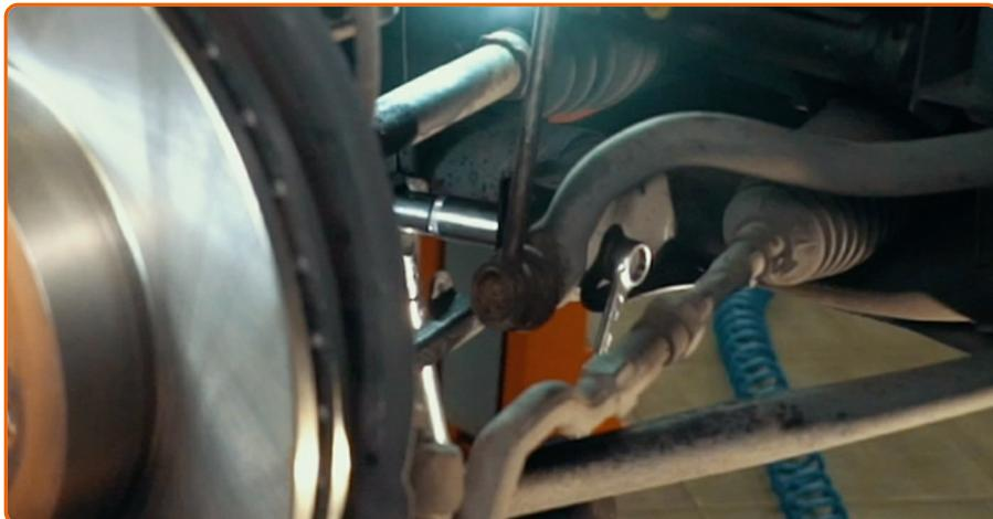
Schrauben Sie die Befestigungen fest, die den Querlenker mit dem Hilfsrahmen verbindet. Verwenden Sie Ring-Gabelschlüssel Nr. 16. Verwenden Sie Stecknuss Nr. 18. Verwenden Sie einen Drehmomentschlüssel. Ziehen Sie ihn mit 87 Nm Drehmoment fest.
