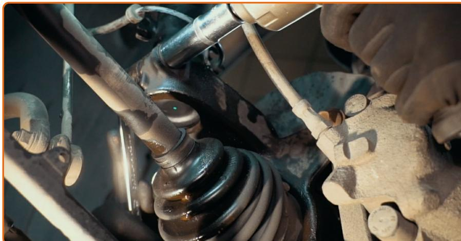
Schrauben Sie das Befestigungselement ein, das das Federbein mit dem Achsschenkel verbindet. Verwenden Sie Ring-Gabelschlüssel Nr. 16. Verwenden Sie Stecknuss Nr. 18. Verwenden Sie einen Ratschenschlüssel.
