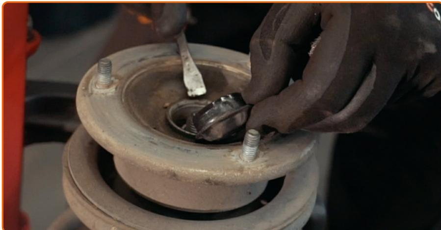
Entfernen Sie die Kappe des Federbeinstützlagers. Benutzen Sie ein Brecheisen.
