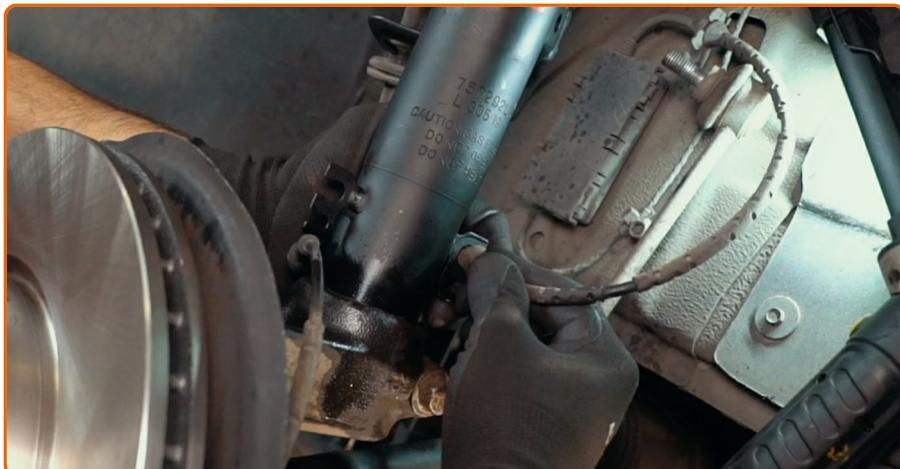
Verbinden Sie das ABS mit der Sensorverdrahtung.
