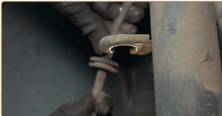
Trennen Sie den Bremsschlauch.
