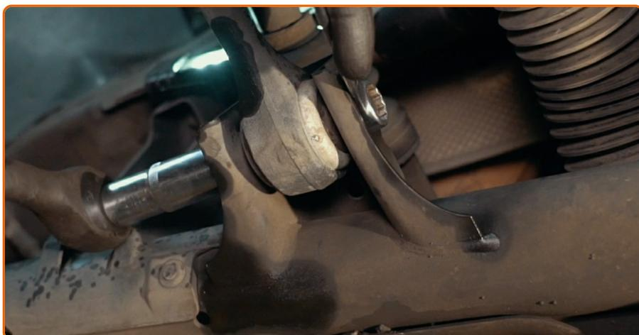
Schrauben Sie das Befestigungselement ein, das den Querlenker mit dem Hilfsrahmen verbindet. Verwenden Sie Ring-Gabelschlüssel Nr. 16. Verwenden Sie Stecknuss Nr. 18. Verwenden Sie einen Ratschenschlüssel.
