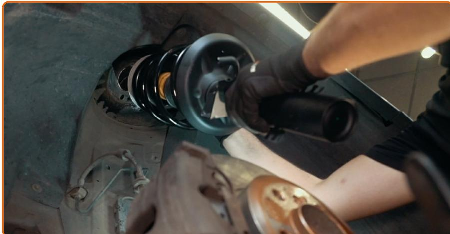
Installieren Sie das Federbein am Radlauf.
