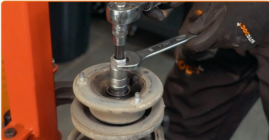
Entfernen Sie die Stangenmutter des Federkolben. Verwenden Sie Stecknuss Nr. 21. Verwenden Sie Inbusschlüssel Nr. H6. Verwenden Sie einen Ratschenschlüssel.
