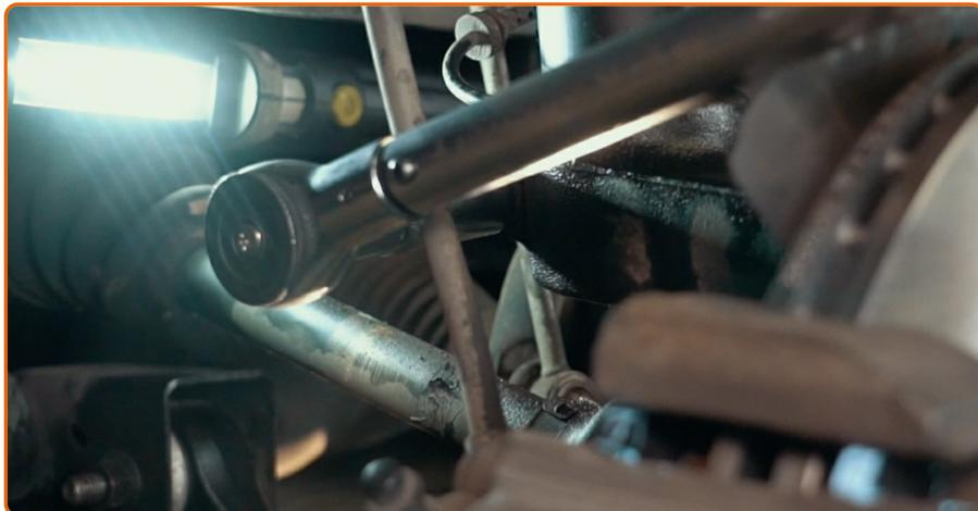
Ziehen Sie die untere Befestigung des Stoßdämpfers an. Verwenden Sie Stecknuss Nr. 16. Verwenden Sie Stecknuss Nr. 18. Verwenden Sie einen Drehmomentschlüssel. Ziehen Sie ihn mit 79 Nm Drehmoment fest.
