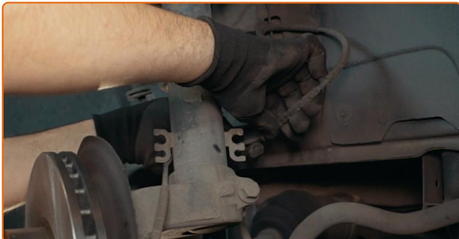
Trennen Sie die ABS Sensorverdrahtung.
