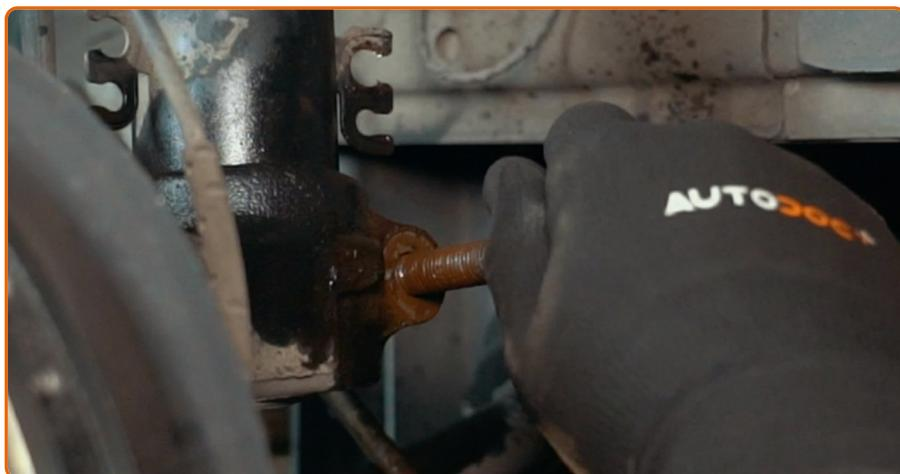
Entfernen Sie die Befestigungsschraube.
