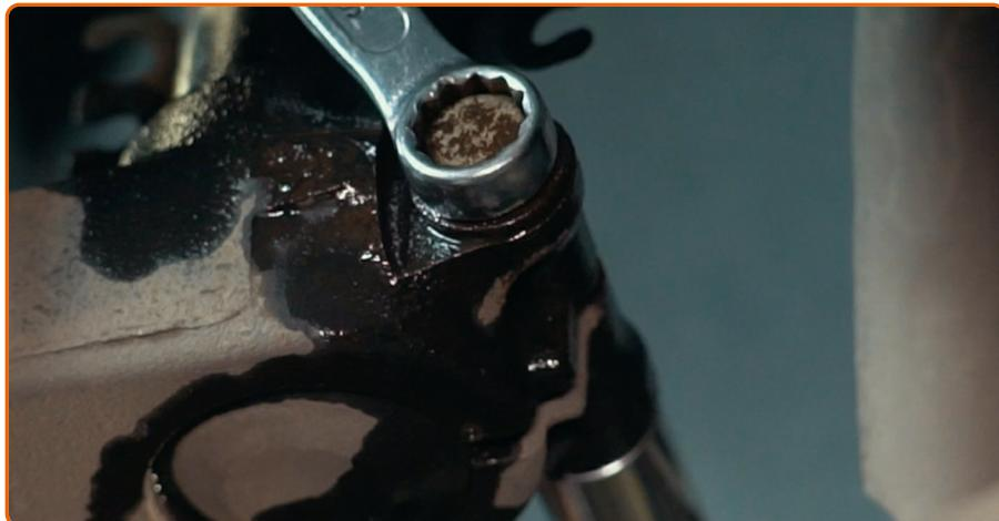
Schrauben Sie das untere Befestigungselement ab, dass das Federbein mit dem Achsschenkel verbindet. Verwenden Sie Ring-Gabelschlüssel Nr. 16. Verwenden Sie Stecknuss Nr. 18. Verwenden Sie einen Ratschenschlüssel.
