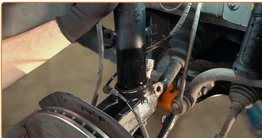
Befestigen Sie das Dämpferbein auf dem Achsschenkel.
