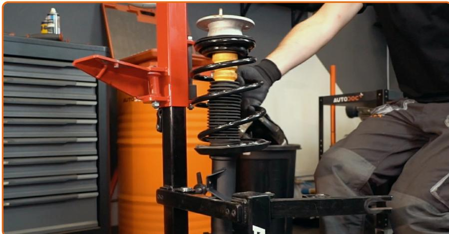
Entfernen Sie das zusammengebaute Federbein.
