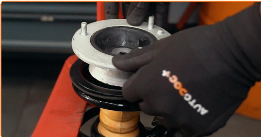
Setzen Sie das neue obere Federbeinlager ein.
