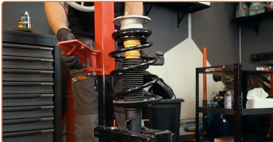
Dekomprimieren Sie die Feder.
