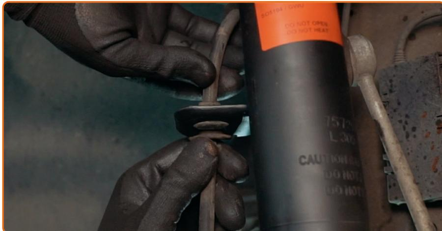
Befestigen Sie den Bremsschlauch.
