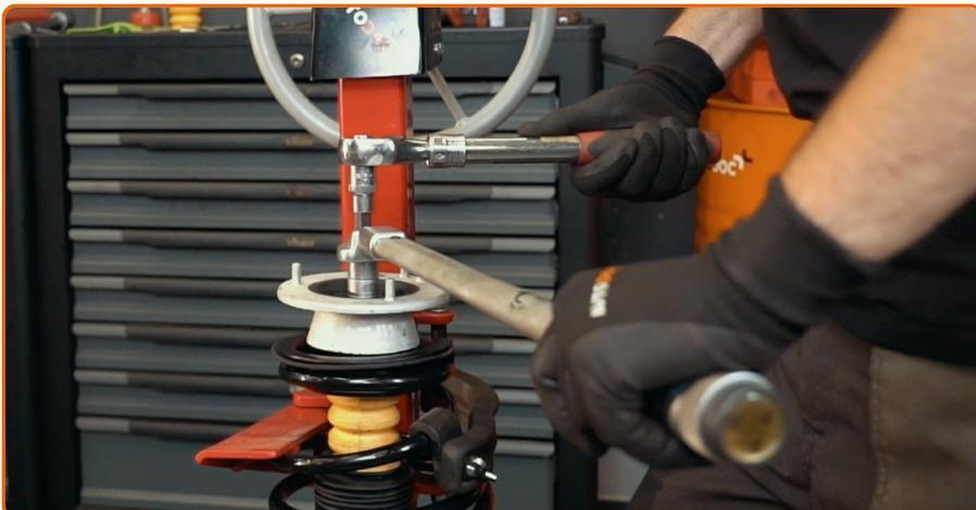
Ziehen Sie die Federbeinkolbenstangenmutter an. Verwenden Sie Stecknuss Nr. 19. Verwenden Sie Inbusschlüssel Nr. H6. Verwenden Sie einen Drehmomentschlüssel. Ziehen Sie ihn mit 51 Nm Drehmoment fest.
