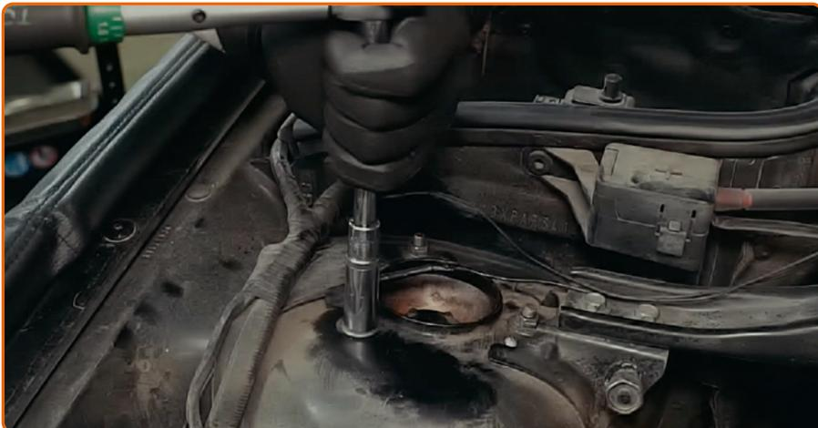
Ziehen Sie die oberen Befestigungen des Federbeins an. Verwenden Sie Stecknuss Nr. 13. Verwenden Sie einen Drehmomentschlüssel. Ziehen Sie ihn mit 32 Nm Drehmoment fest.
