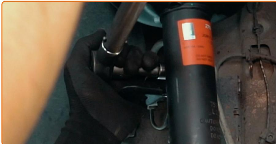
Ziehen Sie das Befestigungselement an, das die Druckstange mit dem Federbein verbindet. Verwenden Sie Stecknuss Nr. 16. Verwenden Sie einen Drehmomentschlüssel. Ziehen Sie ihn mit 65 Nm Drehmoment fest.
