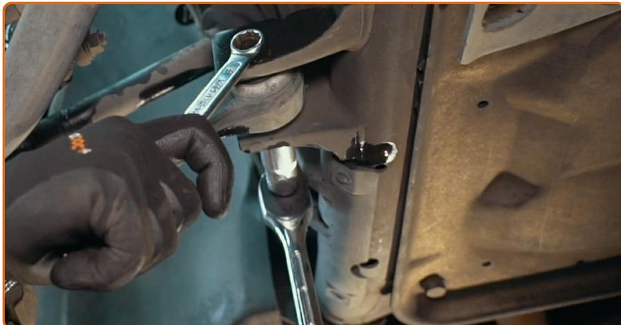
Schrauben Sie die Befestigung ab, die den Querlenker mit dem Hilfsrahmen verbindet. Verwenden Sie Ring-Gabelschlüssel Nr. 16. Verwenden Sie Stecknuss Nr. 18. Verwenden Sie einen Ratschenschlüssel.
