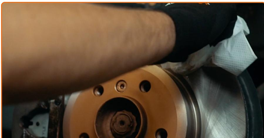
Die Bremsscheibenoberfläche reinigen. Benutzen Sie einen Bremsenreiniger.
